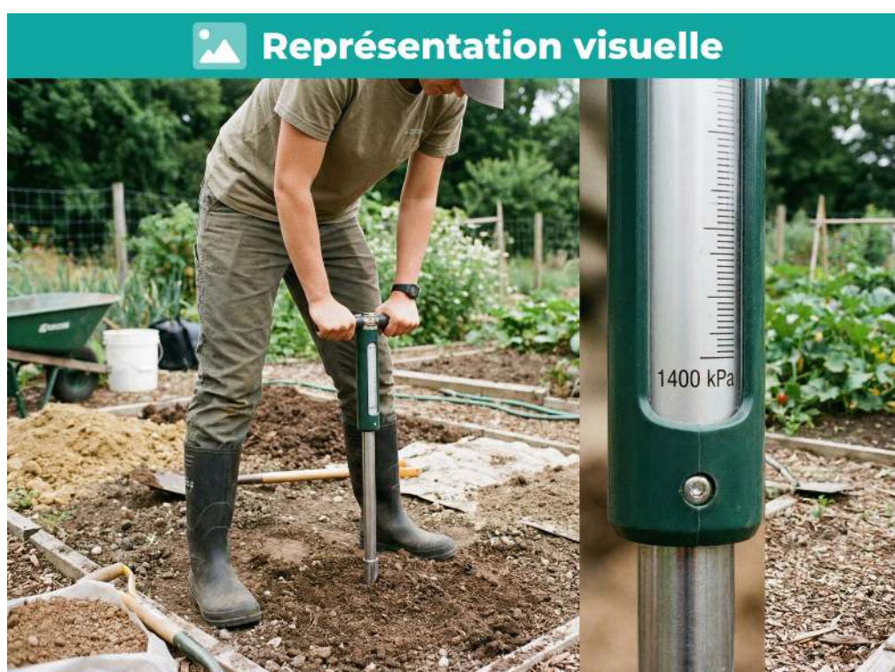
Mesure de la portance du sol pour garantir la sécurité des aménagements
